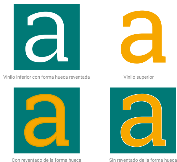
17. Con el hueco reventado, el vinilo superior se solapa sin fisuras con el vinilo inferior.
