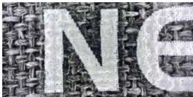
15. Marca sobre producto entelado, impresa mediante serigrafía.
