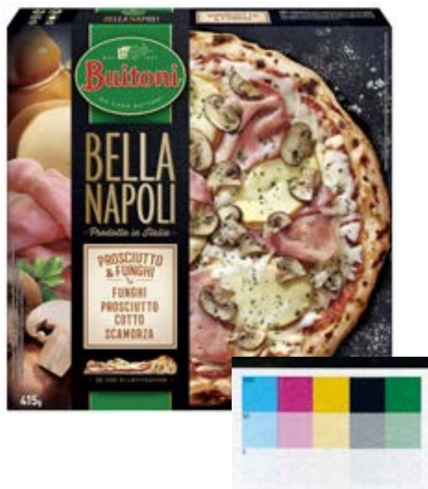
13. Envase en cuatricromía más tinta verde, con detalle de las muestras de tramado.
